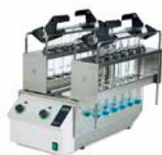
ケルダール分解器 硫酸が漏れることなく、素早い加熱 (通常で1-2時間程度)
